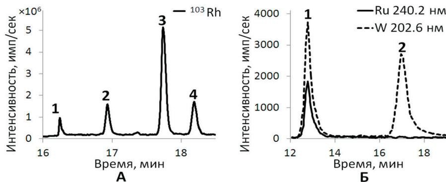
Рисунок 1. А – КЭ-ИСП-МС электрофореграмма смеси полиядерных комплексов родия  $[\text{Rh}_y(\text{OH})_m(\text{H}_2\text{O})_z]^{3y-m}$ .
