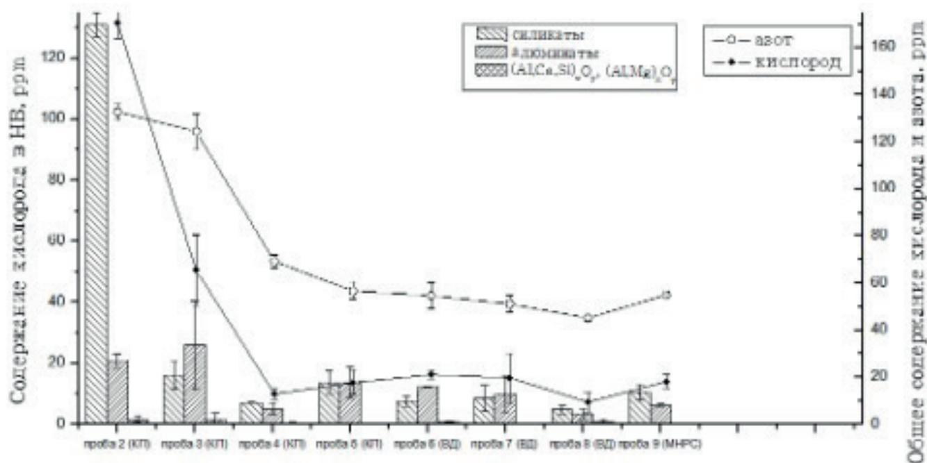
Видно, что происходит увеличение содержания азота и неметаллических включений в пробе металла на МНЛЗ, это свидетельствует о вторичном окислении металла во время разлива. Проведенный анализ позволил дать рекомендации по совершенствованию технологии внепечной обработки.
