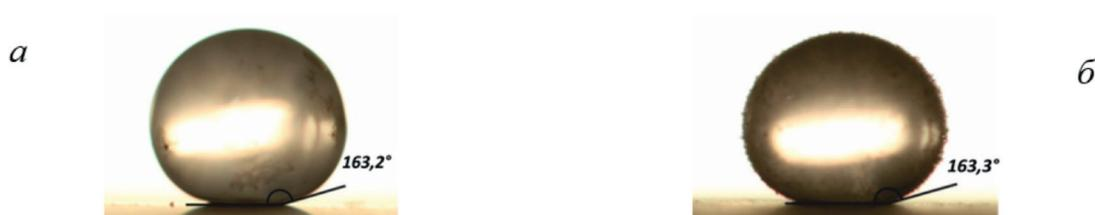
Рисунок 1. Краевой угол смачивания модифицированных частиц диоксида кремния:
