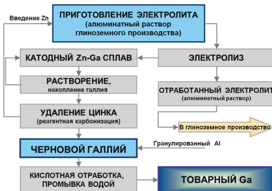
Рисунок 1. Принципиальная технологическая схема извлечения галлия
