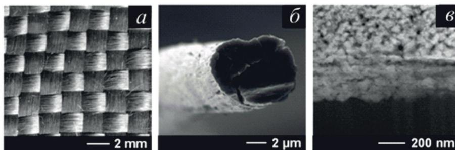
Микроизображения текстильного материала на основе волокон SiC, полученного путём силицирующей обработки углеродной ткани газообразным SiO
