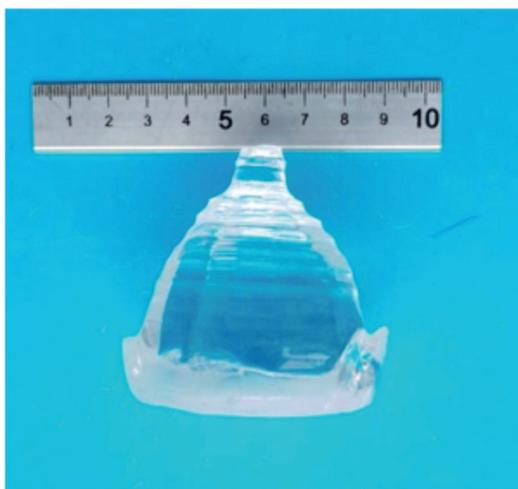
Рисунок 1. Стандартная форма кристалла  $\text{Li}_2\text{W}_{1-x}\text{Mo}_x\text{O}_4$ ,  $x = 0,1$
