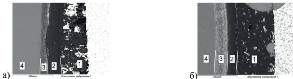
Рисунок 1. Микроструктура окисленных сплавов состава (в ат.%): а) Co91.7Re5.5Nb2.8; б) Co88.8Re9.3Ta1.9.
