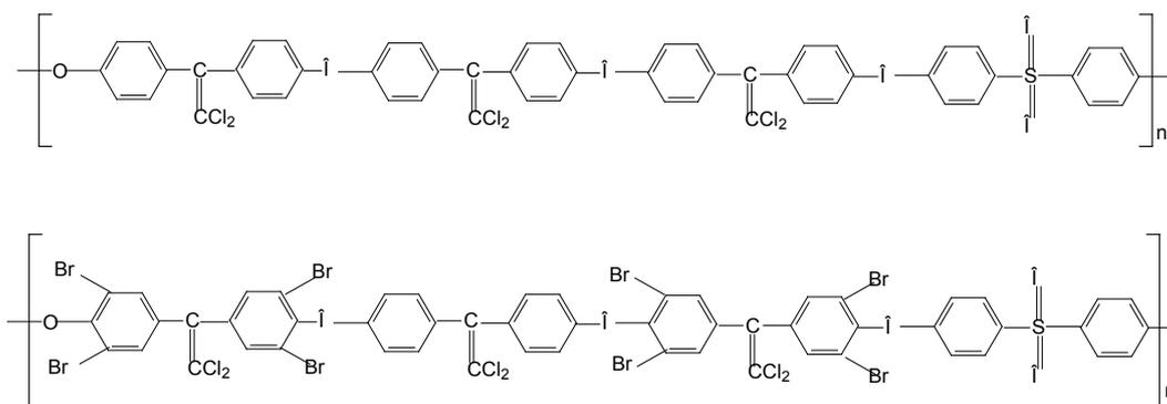
Синтезированные ПЭС, содержащие в основной цепи дихлорэтиленовые группы, хорошо растворимы в легколетучих растворителях, обладают пленкообразующими свойствами, что открывает широкие возможности для получения из них пленочных материалов и покрытий. При термообработке ПЭС на основе мономера (I) способен образовывать сшитые структуры. При этом существенно повышаются тепло-, термо- и гидролитическая стойкость полимера.
